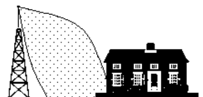
MITIGAZIONE PER MODIFICA DI INCLINAZIONE DELL'ANTENNA (TILT)
