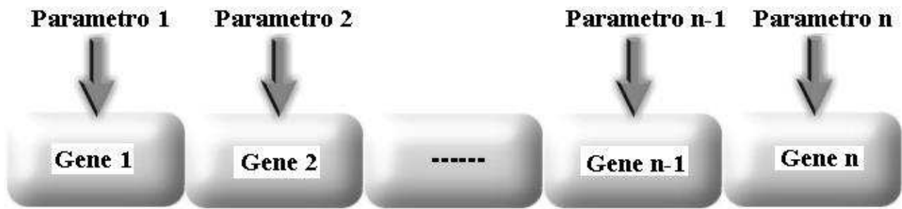
Fig.10 Codifica dei parametri soluzione in termini di geni del cromosoma.
