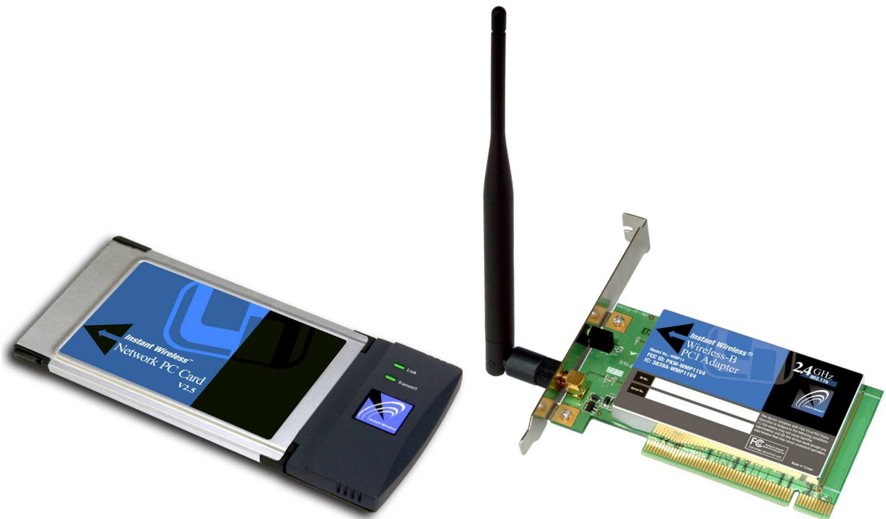
Fig.3 Immagine di tipiche schede wireless: formato PCMCIA per computer portatile con antenna interna (a sinistra) e su bus PCI per computer fisso con antenna esterna (a destra).
